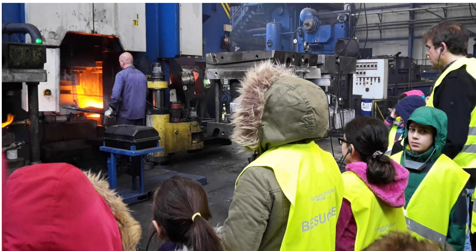
*Laut, heiß, und unglaublich beeindruckend: Metallteile werden hier **auf 1.200 ° Celcius erhitzt** und mit einem **135 Tonnen schweren Hammer** zu einer flachen Scheibe umgeformt.*
